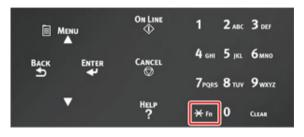
**9** Enter «9» «0» using the numeric keypad and then press the «ENTER» button.
