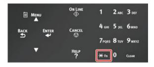
**2** Press the numeric keys (0-9) to display the desired function item and press the «ENTER» button.
